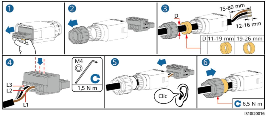
**Figura 5-7** Cable de cuatro conductores (L1, L2, L3 y conexión a tierra)
