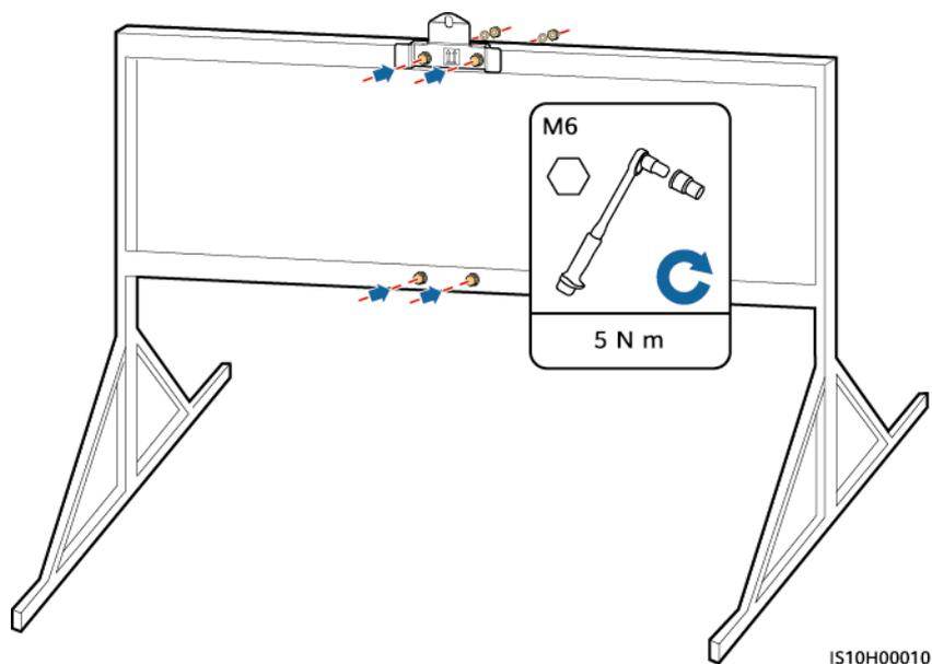
**Paso 4** Instale el SUN2000 en la ménsula de montaje.
