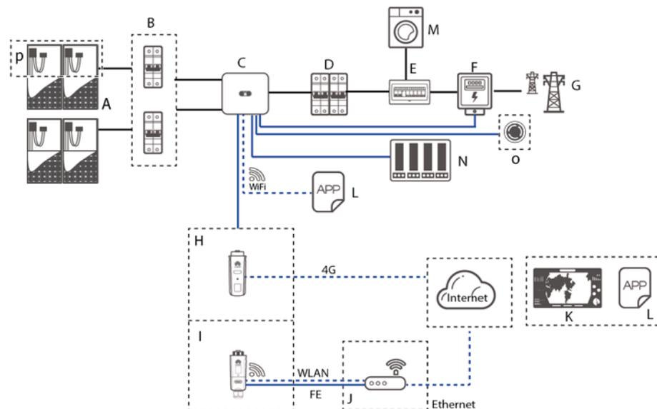
**Figura 2-3** Aplicación de la conexión en red en caso de conexión en cascada de inversores (opcional en los recuadros de línea discontinua)
