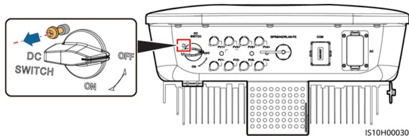
**Paso 3** Si entre la cadena fotovoltaica y el inversor hay un interruptor de CC, enciéndalo.
