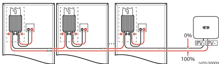
**Paso 4** Coloque el interruptor DC en posición OFF y compruebe si están dañados el conector o el cable de CC entre los posibles módulos fotovoltaicos con fallos y los optimizadores
