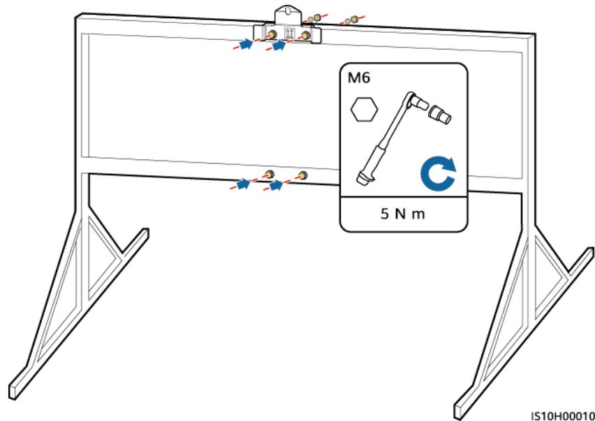
**Paso 4** (Opcional) Instale el tornillo de bloqueo para el interruptor de CC.
