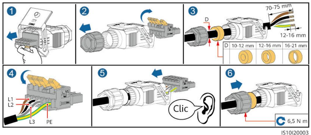
**Figura 5-7** Cable de cuatro conductores (L1, L2, L3 y neutro)
